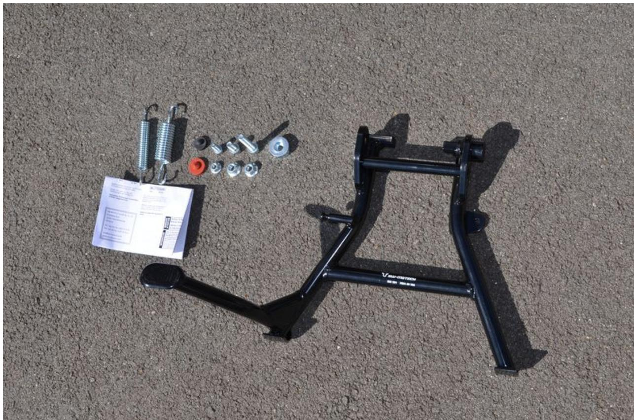
On attaque, j'ai dévissé les deux vis qui soutiennent le silencieux afin d'avoir un peu de marge pour la vis de droite de la béquille.
