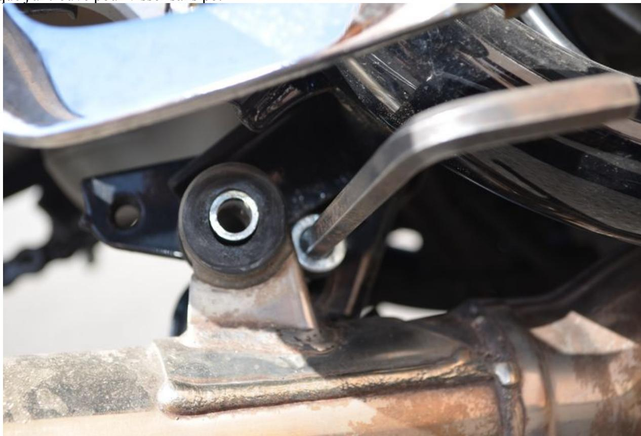
On visse a fond jusqu'à ce que la vis rentre dans le support de béquille et vienne butter sur la béquille.
