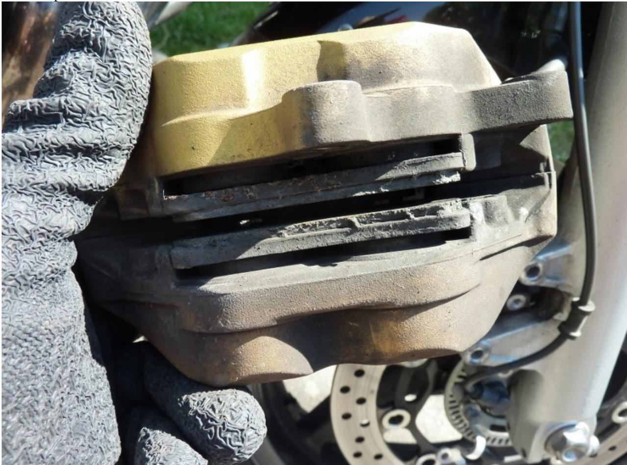
on écarte les 2 plaquettes avec un tournevis pour repousser les pistons
