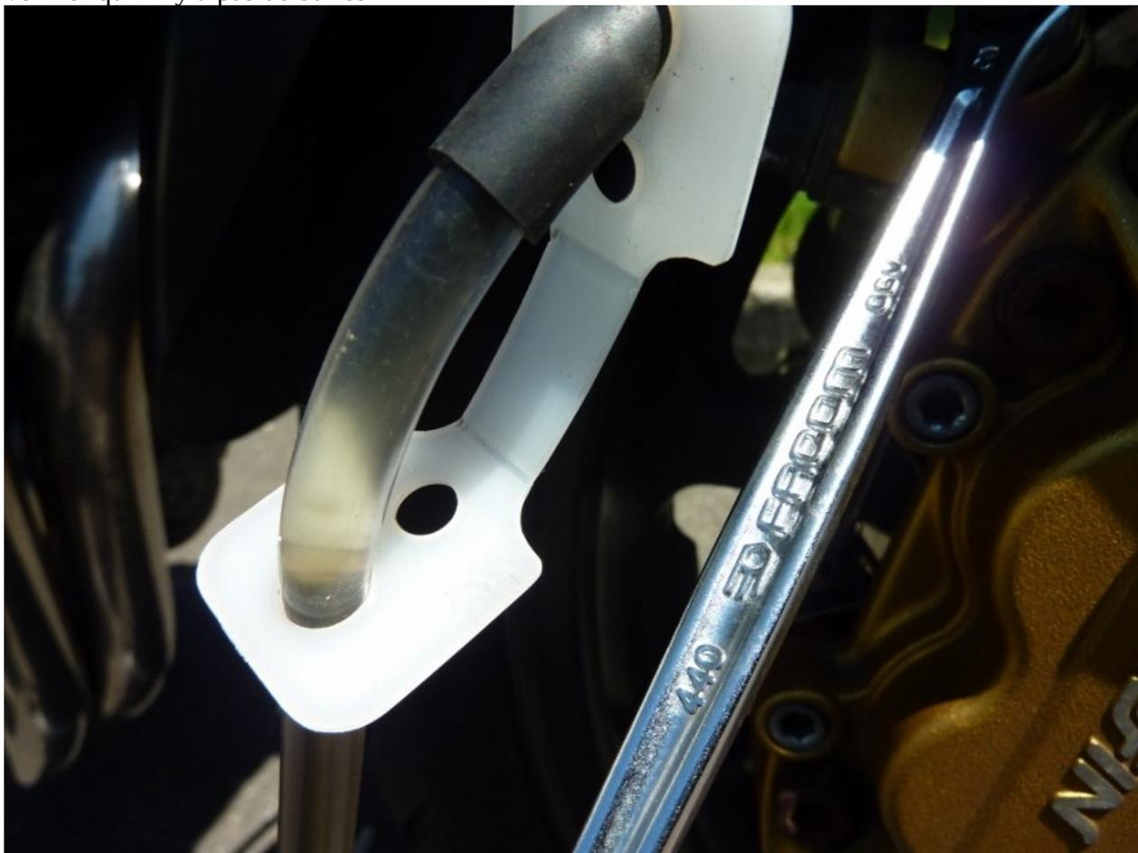
serrer la vis de purge, nettoyer le liquide et reposer le capuchon caoutchouc
