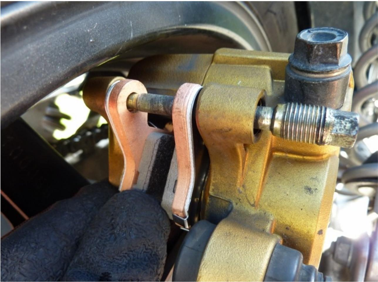
faire descendre l'étrier pour replacer les plaquettes de part et d'autre du disque, tout en maintenant les 2 plaquettes, sinon le ressort retombe
