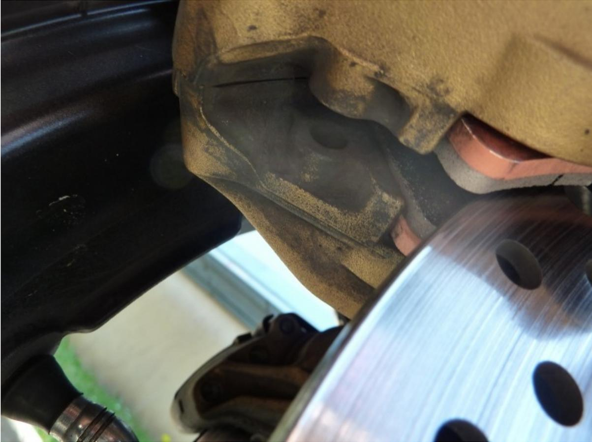
pareil pour la vis d'en bas, sans le serrer pour l'instant (attendre que l'étrier soit fermement fixé)
