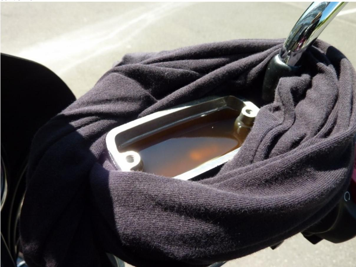
retirer du liquide avec une seringue pour qu'il ne déborde pas (ce liquide est corrosif)
